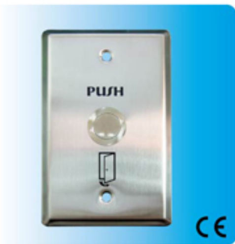
型號:PG-BUTN-21100 尺寸:120(L) x 75(W) x 5(H)mm 接點: N.O. / COM.
