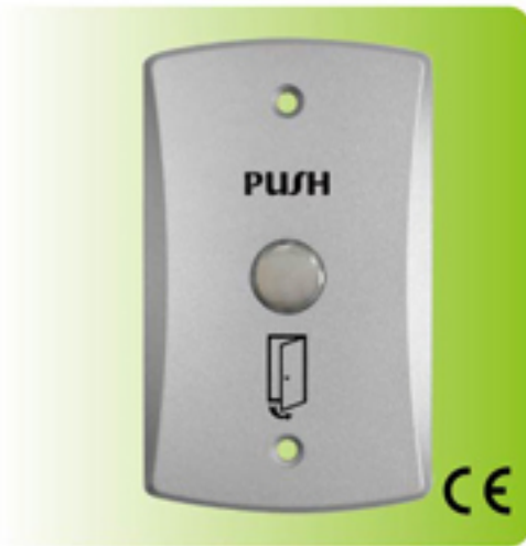
型號:PG-BUTTON-09/N 尺寸:115(L) x 70(W) x 5(H)mm 接點: N.O. / N.C. / COM.
