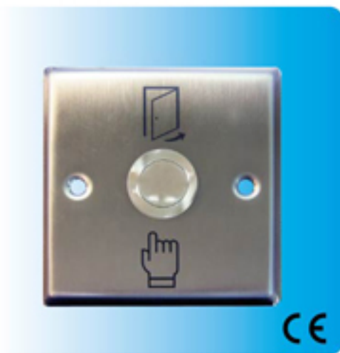
型號:PG-BUTN-286 尺寸:86(L) x 86(W) x 5(H)mm 接點: N.O. / COM.
