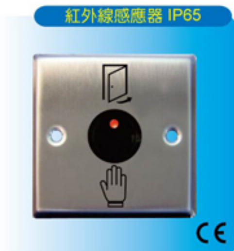
型號:PBT-286/IRA 尺寸:86(L) x 86(W) x 5(H)mm (通電時: 紅燈 / 感應時: 藍燈) 可暫態/常態切換 接點:N.O. / N.C. / COM.
