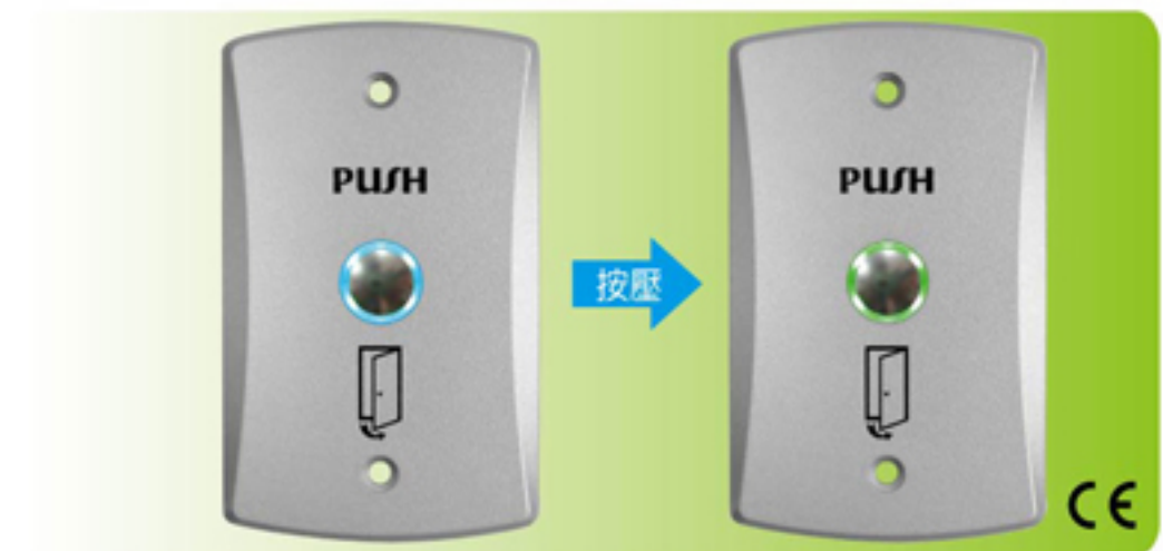
型號:PG-BUTTON-09/BG 尺寸:115(L) x 70(W) x 5(H)mm (通電時: 藍燈 / 按壓時: 綠燈) 接點: N.O. / N.C. / COM.
