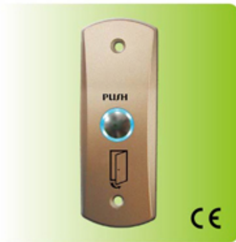
型號:PG-BUTTON-08 尺寸:115(L) x 42(W) x 5(H)mm 藍色 LED 指示燈 接點: N.O. / N.C. / COM.
